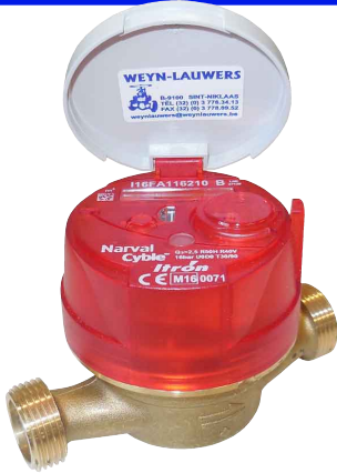
NARVAL watermeter 3/4" geschikt voor warm- en koud water horizontale plaatsing : klasse B vertikale plaatsing : klasse A vooruitgerust voor pulszen- der optie : pulszen- der CYBLE
