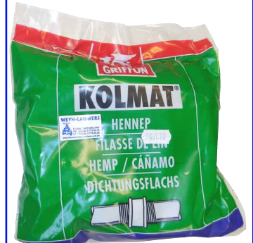
HENNEP / KEMP geschikt voor metalen schroefdraad- verbindingen niet geschikt voor gas temp. : -20°C +130°C streng : 200 gram
